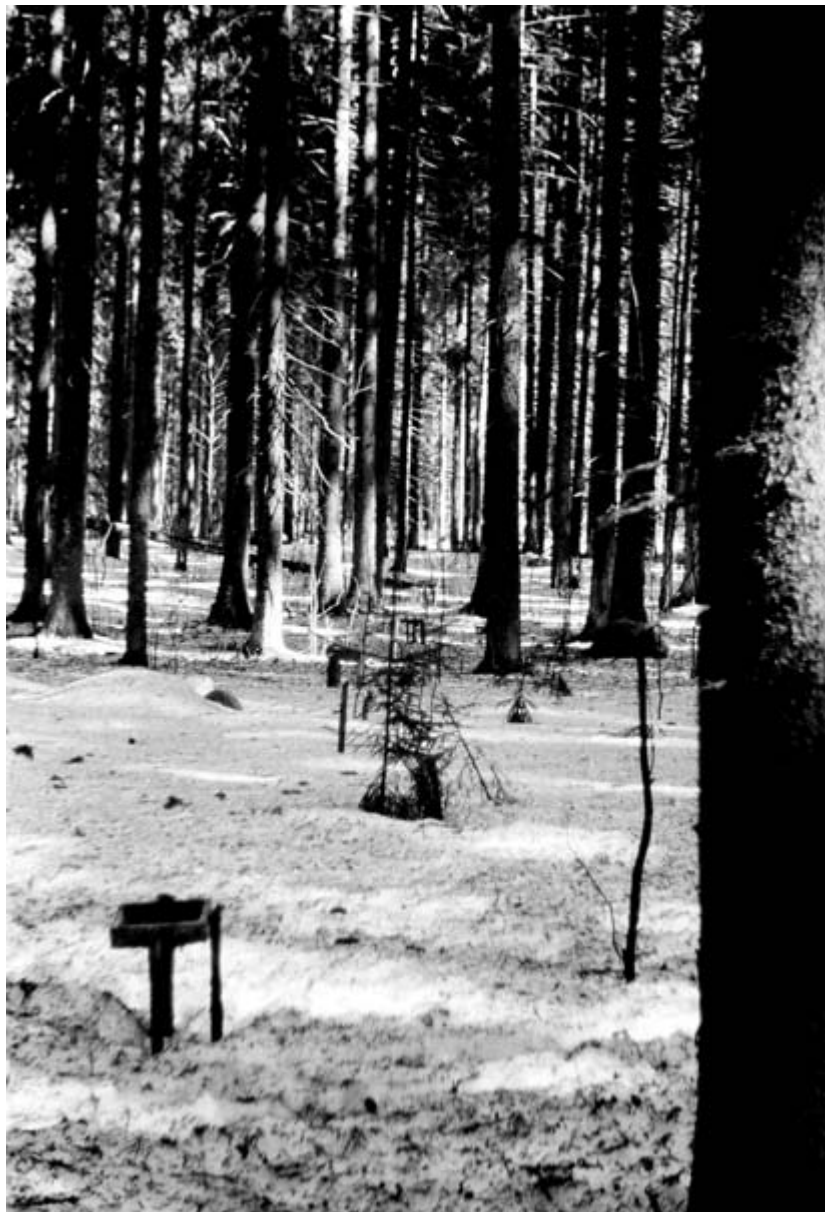
Рисунок 5. Опадуловители, которые использовались и для учета выпавших семян ели. Пробная площадь в ельнике кисличном. Март 1979 г.
